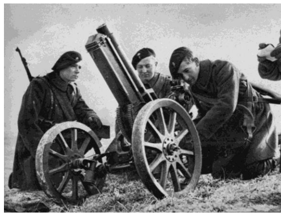
Mor 76 F.R.C. du 1 er Chasseurs ardennais avec sa lunette et sa hausse à tambour, système de visée de qualité digne de l'artillerie moderne de l'époque. (Coll. privée).
