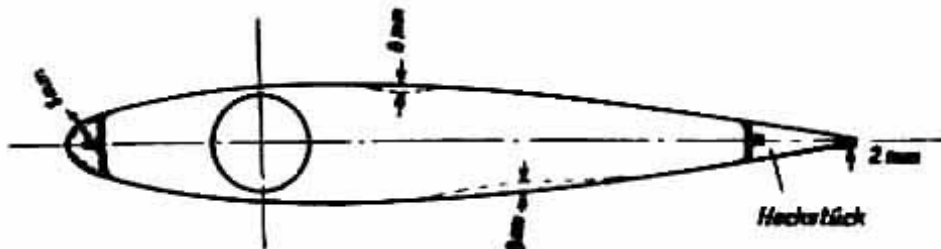
Abb. 4: Zulässige Beschädigungen am Flügel
