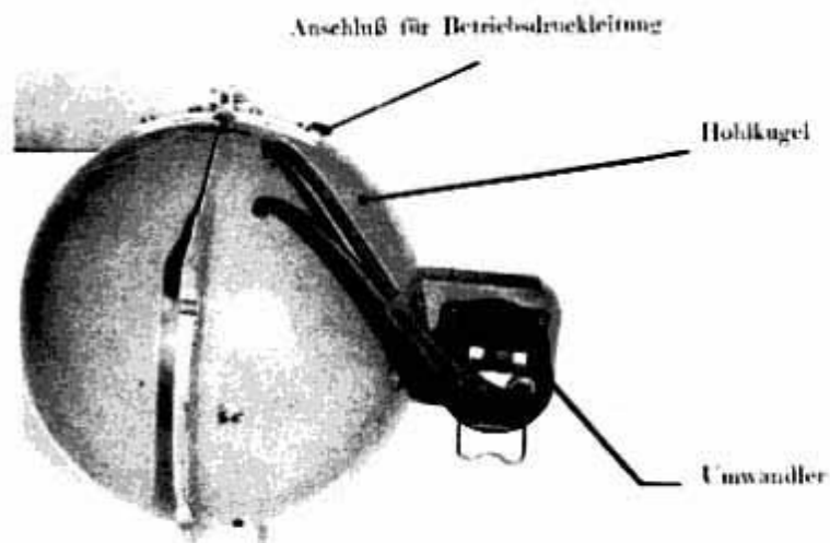
Abb. 35: Kompaß-Hohlkugel mit Umwandler
