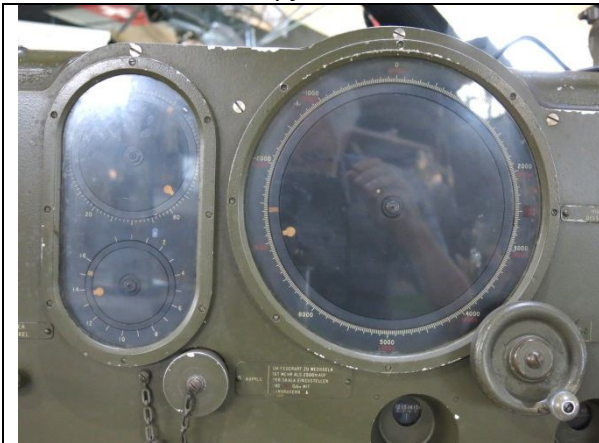
Flughöhe (rechts) und Lagewinkel (links) müssen am Rechner andauernd von Hand „nachgeführt“ werden. Rechts unten das Handrad zur manuellen Nachführung der Flughöhe, welche im Gerät bereits bekannt ist (Eingang vom Telemeter her).
