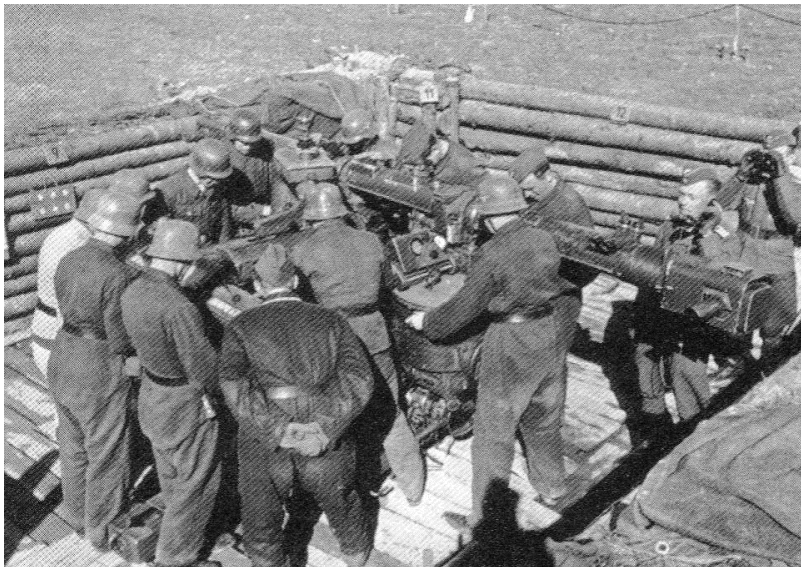
12 von 14 Mann bedienen den Flugbahn-Rechner: Deutsches Kommandogerät 36 mit aufgesetztem Telemeter. In der Bildmitte der runde „Flugrichtungstisch“.
