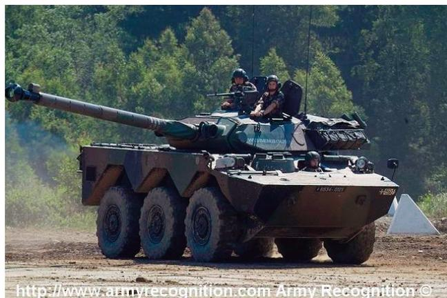
migènes. La conduite de tir, particulièrement étoffée pour l'époque, comprenant un calculateur, un télémètre laser, une caméra de télévision à bas niveau de lumière avec un écran pour le chef d'engin et le pilote, permettant l'engagement de jour comme de nuit. Le véhicule est amphibie, des hydrojets le propulsant à une vitesse d'environ 7km/h. Sur terre, la vitesse maximale atteint 85km/h sur route, pour une autonomie d'environ 800 kilomètres.
